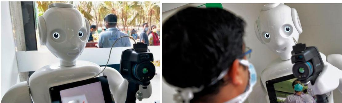
Paso 3: El termómetro va a evaluar la temperatura de la persona y mostrará el resultado en una pantalla
